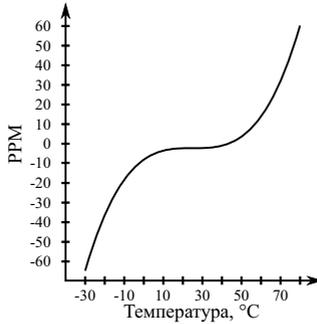
Рис. 6. Зависимость частоты быстрого кварцевого резонатора от температуры [16].
