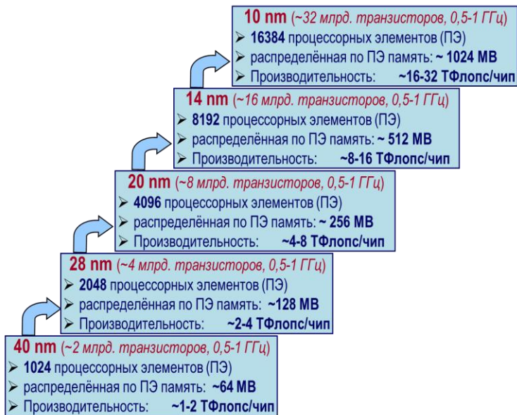
Рис. 2. Пропорциональное наращивание вычислительных возможностей однокристалльных реализаций высокопараллельной архитектуры ПС-2000М по мере развития промышленных СБИС-технологий
