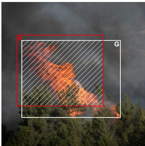
РИСУНОК 6. Расчет IoU между реальным (G) и обнаруженным результатом (P)
