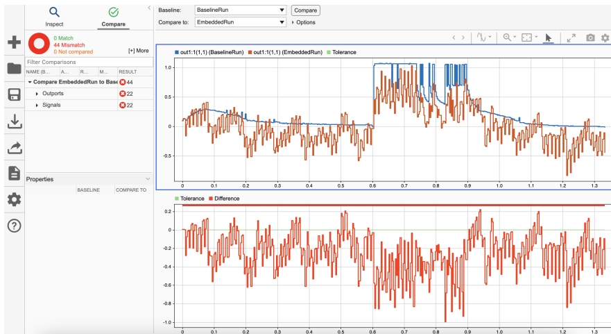
Рисунок 7. Сравнение выходных сигналов исходной (синий график) и целочисленной модели (красный график) нейронной сети
