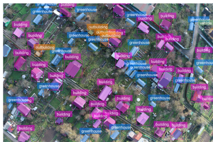
Рисунок 13. ConvNeXt-T, погрешность контуров масок \approx 7\%
