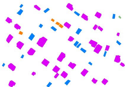
Рисунок 10. ResNet-101, погрешность контуров масок \approx 10\text{--}11\%
