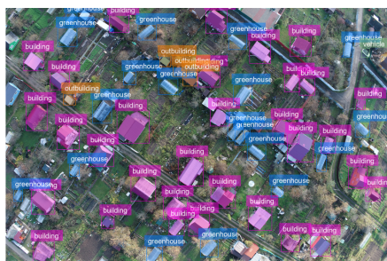
Рисунок 9. ResNet-50, погрешность контуров масок \approx 15\%
