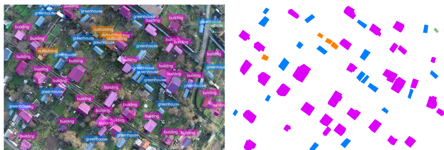
Рисунок 15. Swin-S (погрешность контуров масок \approx 1\text{--}2\% )
