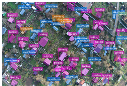
Рисунок 10. ResNet-101, погрешность контуров масок \approx 10\text{--}11\%
