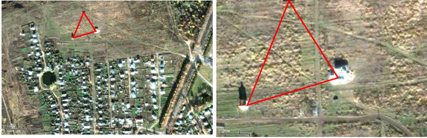
Рис. 5. Определение высоты БПЛА в случае камеры направленной вертикально вниз (слева – ориентиры на карте местности, справа – снимок с бортовой камеры БПЛА)
