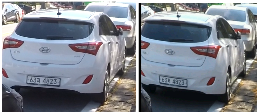
Рисунок 5. Оригинальное изображение до стабилизации и артефакт с наклоном автомобиля при использовании профиля Constant High метода MeshFlow
