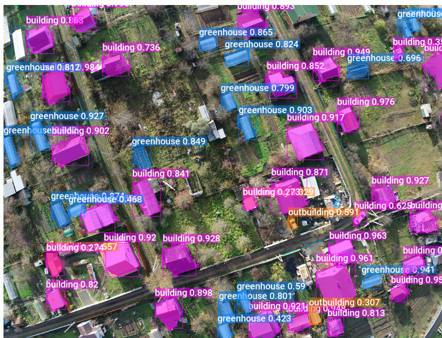
Рисунок 14. Результаты детектирования объектов разных типов с использованием YOLO
