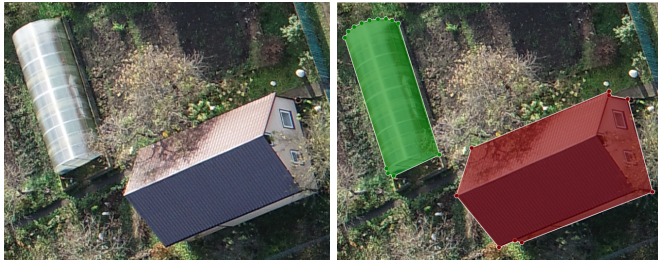
(а) Фрагмент изображения с дачным домиком и теплиц (б) Контуризация объектов 2-х типов
