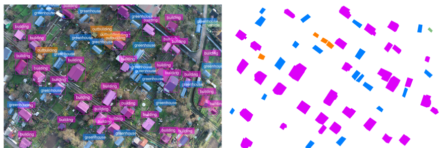
Рисунок 15. Swin-S (погрешность контуров масок \approx 1\text{--}2\% )
