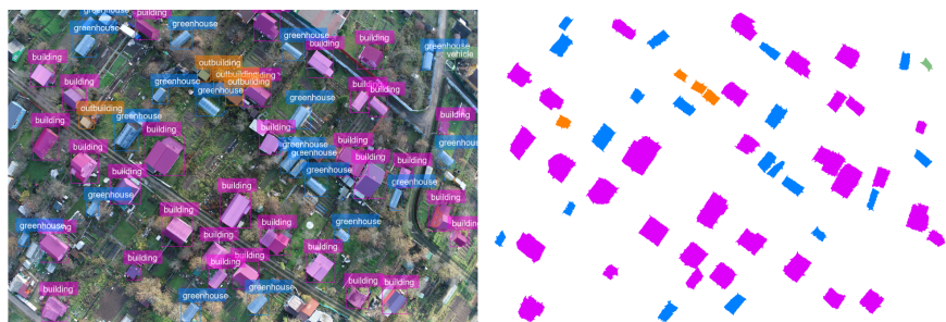
Рисунок 9. ResNet-50, погрешность контуров масок \approx 15\%
