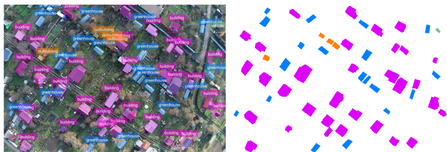
Рисунок 10. ResNet-101, погрешность контуров масок \approx 10\text{--}11\%
