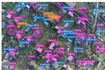
Рисунок 11. DenseNet-121, погрешность контуров масок \approx 12\%
