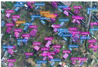
FIGURE 12. EfficientNet-B3 (contour detection error \sim 10\text{--}11\% )
