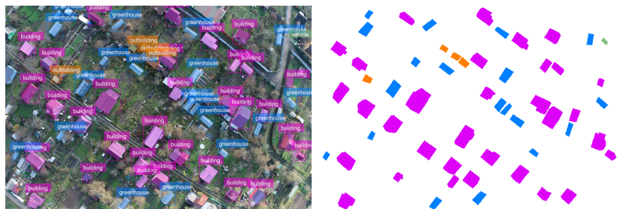
Рисунок 14. Swin-T, погрешность контуров масок \approx 3\text{--}5\%
