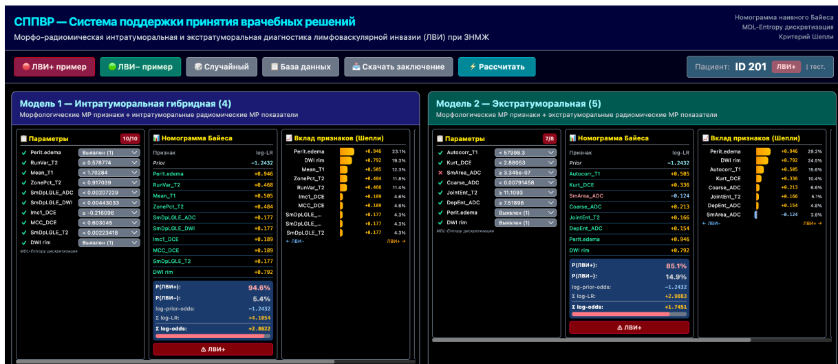
Рисунок 2. Прототип системы поддержки принятия врачебных решений «Морфо-радиомическая диагностика ЛВИ при ЗНМЖ». Слева – интратуморальная модель, справа – экстратуморальная. Прототип реализован как автономное веб-приложение на базе наивного Байеса с лапласовским сглаживанием ( \alpha = 1 ), MDL-Entropy дискретизацией порогов, расчётом Shapley score, log-likelihood ratio признака.
