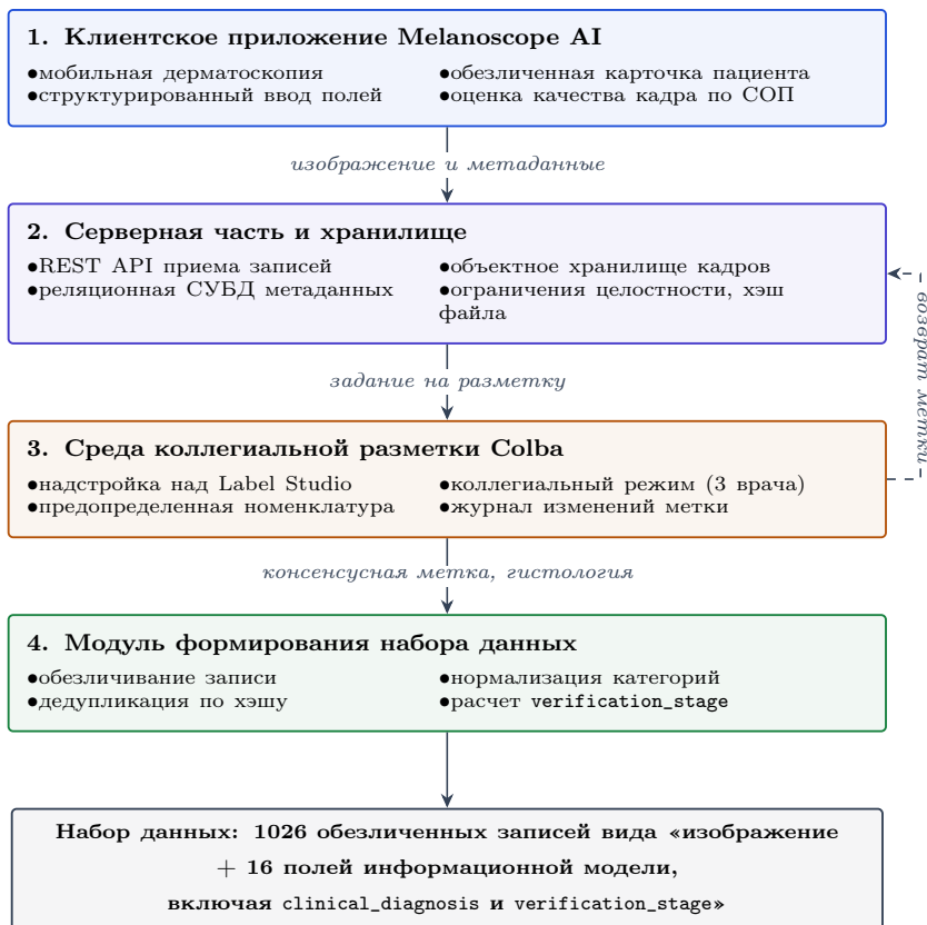
Рисунок 2. Архитектура программного комплекса подготовки клинически верифицированного набора данных. Пунктирной стрелкой показан возврат согласованной диагностической метки и уровня верификации в основное хранилище
